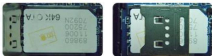
**6.14** Abra la cubierta, presione el interruptor. Luego vuelva a colocar la cubierta frontal.
